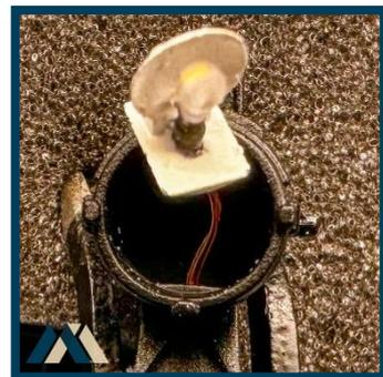
Nun wird der Lackdraht in den eingedruckten Kanal eingeführt und durchgeschoben, ab Austritt unten am Laternenkörper kann mithilfe einer Pinzette der Lackdraht durchgezogen werden. Der Glühbirnensockel mit der befestigten Glühbirne wird nun unter weiterem Ziehen des Lackdrahts in den Laternenkörper eingeführt und mittels Kleber der Wahl befestigt.
