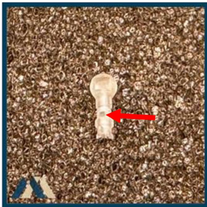
Im Bild mit einem roten Pfeil markiert ist das zweite Loch zur Kabeldurchführung der roten LED der Bauform 0201.
