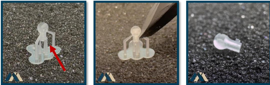
Die Stützstrukturen des Reflektorsockels und der Ringblende entferne ich erst nach dem Grundieren und Lackieren, da die Stützen sich nicht im sichtbaren Bereich befinden und beim Lackieren mit der Pinzette oder sonstigen Halterungen geklemmt werden können.
