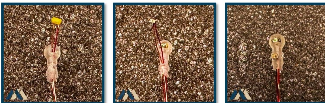
Nach dem Einsetzen werden die LEDs in der Glühbirne von der Hinterseite mit etwas [mattem Klarlack von Vallejo](#) eingeklebt. Bitte darauf achten, dass kein Sekundenkleber, egal welcher Art, verwendet wird. Hintergrund ist, dass der Sekundenkleber das Resin der Glühbirnen klar werden lässt und somit sowohl die LED als auch die Drähte sichtbar werden. Dies schmälert die vorbildnahe Wirkung.
