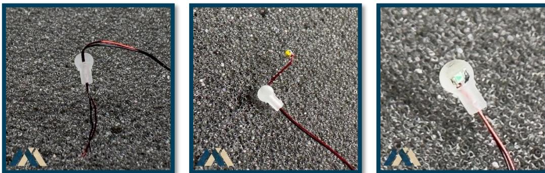
Nach dem Einsetzen wird die LED in der Glühbirne von der Hinterseite mit 1-2 Tropfen [mattem Klarlack von Vallejo](#) eingeklebt. Bitte darauf achten, dass kein Sekundenkleber, egal welcher Art, verwendet wird. Hintergrund ist, dass der Sekundenkleber das Resin der Glühbirnen klar werden lässt und somit sowohl die LED als auch die Drähte sichtbar werden. Dies schmälert die vorbildnahe Wirkung.
