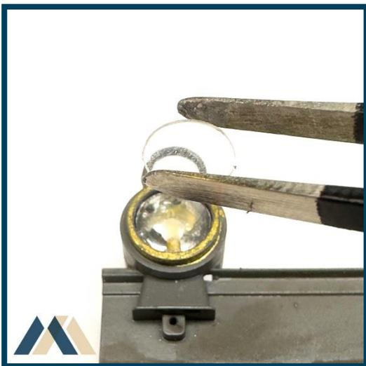
Nach dem Entfernen der Schutzfolien, welche zu beiden Seiten der Scheibe aufgebracht sind, wird diese mit einer Pinzette in die verbleibende Öffnung eingebracht. Sie wird hierzu auf die Öffnung aufgelegt und mit sanftem Druck hineingedrückt, so dass die Scheibe plan zum äußeren Rand liegt.
