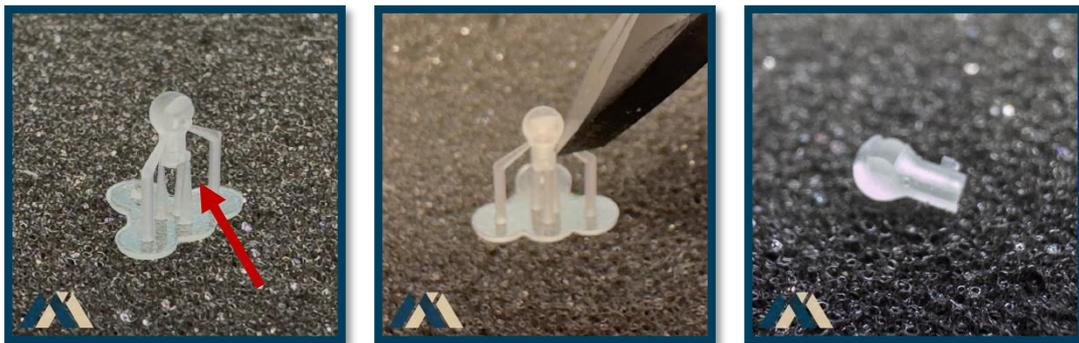
Die Stützstrukturen der Lampenringe und Reflektorgehäuse entferne ich erst nach dem Grundieren und Lackieren, da die Stützen sich nicht im sichtbaren Bereich befinden und beim Lackieren mit der Pinzette oder sonstigen Halterungen geklemmt werden können.
