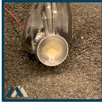
Nun wird der Lackdraht in den eingedruckten Kanal eingelegt und mit Lack oder einem Klebstoff der Wahl darin fixiert.
