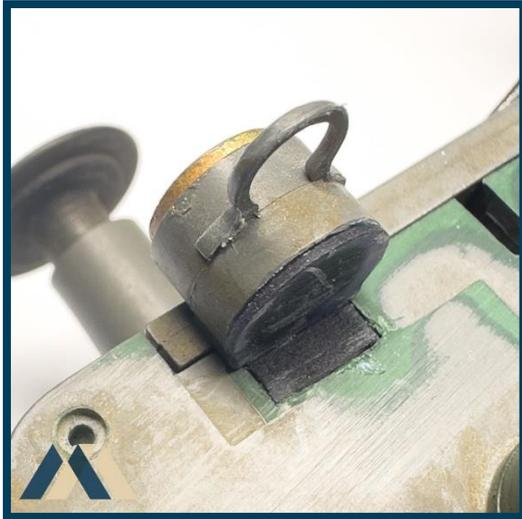
Durch die Passform des Reflektoreinsatzes mit Abdeckung der entstandenen Öffnung an der Rückseite der unteren Laternen, ist gewährleistet, dass die im nächsten Schritt einzusetzende Scheibe ausreichend Platz hat und in der richtigen Position sitzt.
