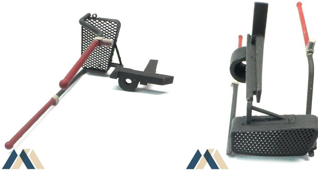
Nach dem Abtrennen können die verbleibenden Stützreste mit einem [Schleifpad](#) mit nicht allzu grober Körnung entfernt werden. Meine Empfehlung ist, die Rangiertritte vor dem Schleifen zu grundieren. Hierdurch werden nicht geschliffene Bereiche oder stehengebliebene Teile von Stützen besser sichtbar.
